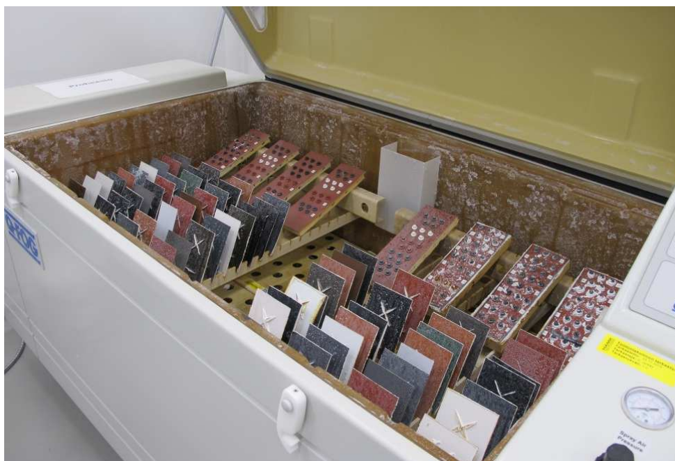
Kuva 1. Näytteet korroosiokaapissa testin lopussa (yhdessä toisten testisarjojen näytteiden kanssa).
