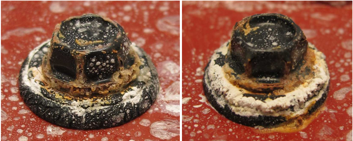
Kuva 4. Ruuvit A (Würth) ja E (Berner) 425 tunnin testauksen jälkeen.
